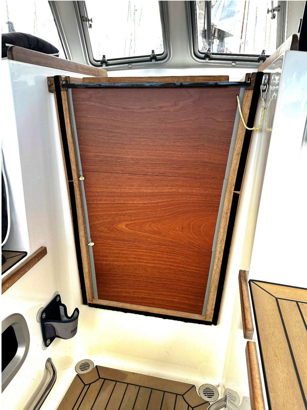
Das dreiteilige „ARC+-Steckschott“ mit Sicherungsbändseln gegen Wegschwimmen nach eingestiegener „Monstersee“...
